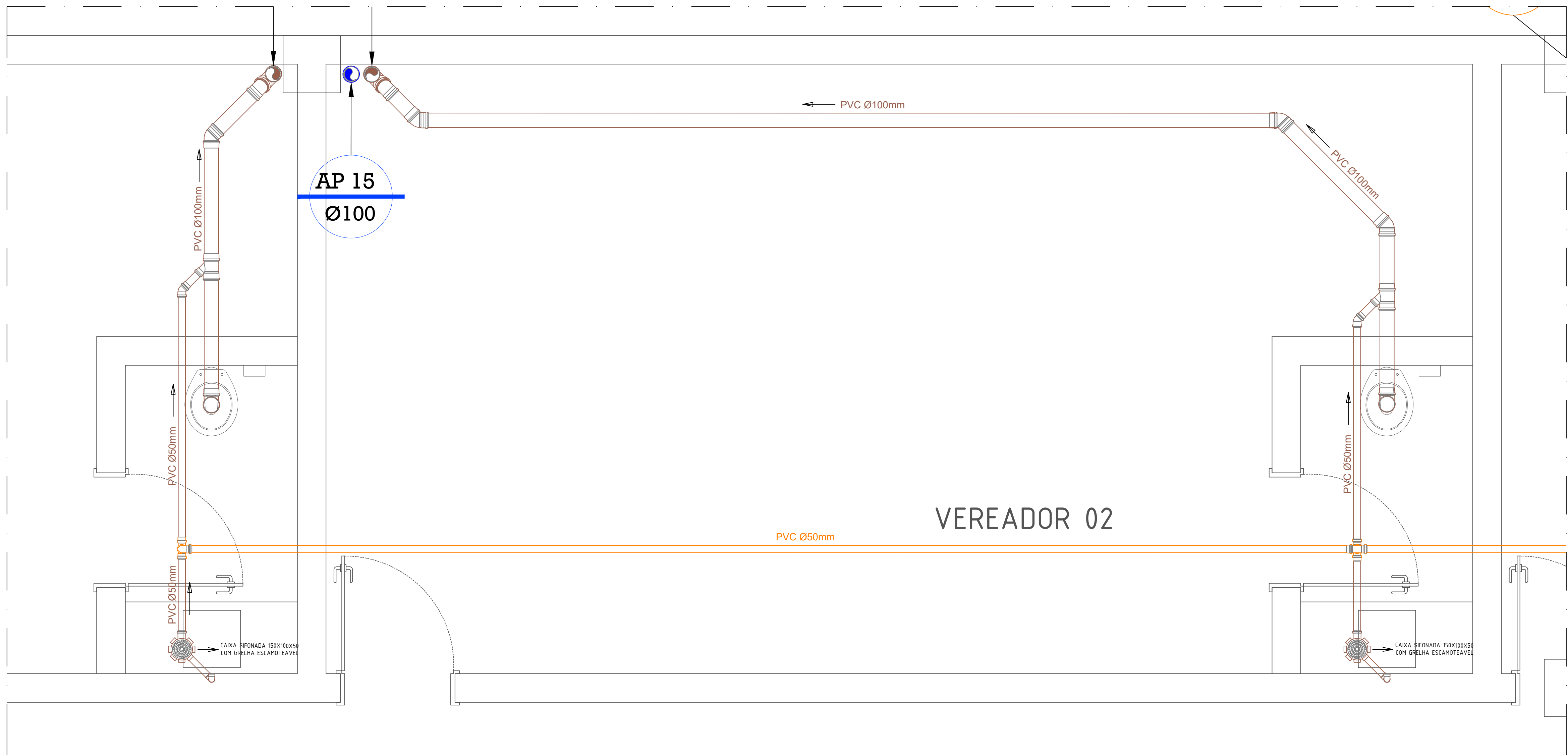
DETALHE BANHEIROS VEREADORES 01 E 02 (1º PAVIMENTO) ESC: 1:25
