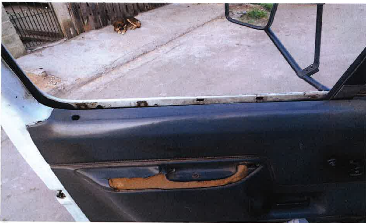
Cabine do motorista em péssimas condições de uso, suja e com peças faltantes.
