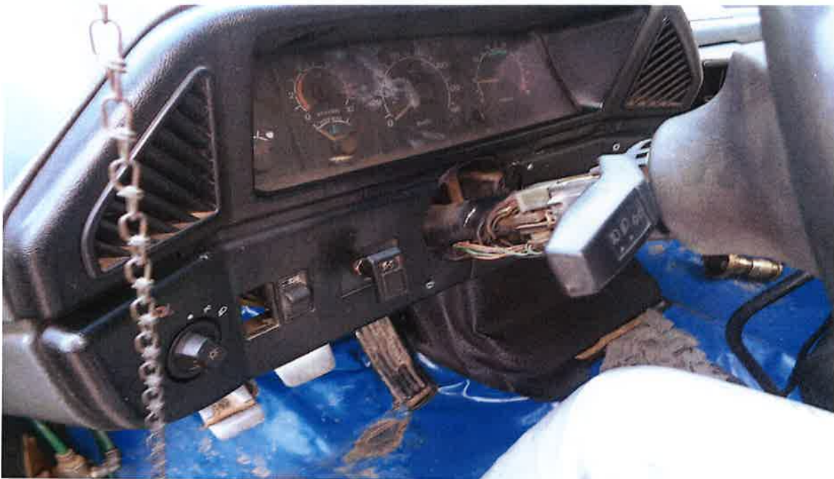
Cabine do motorista em péssimas condições de uso, suja e com peças faltantes.
